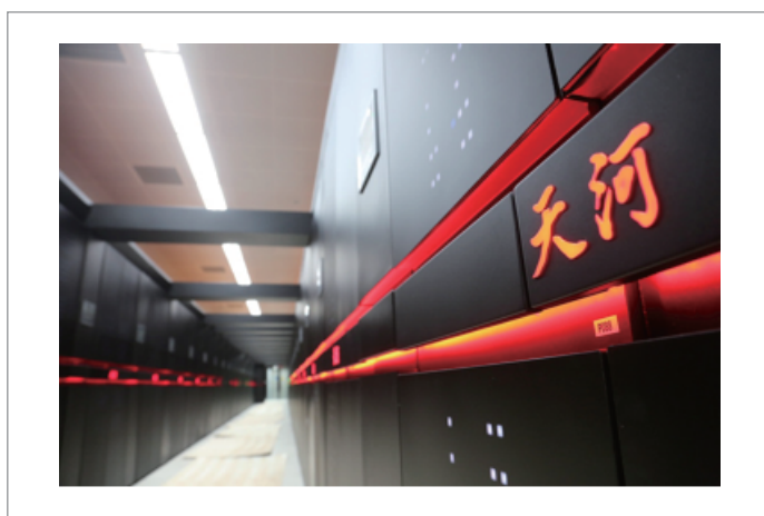
图3 基于飞腾处理器和迈创系列加速器的天河超级计算机
