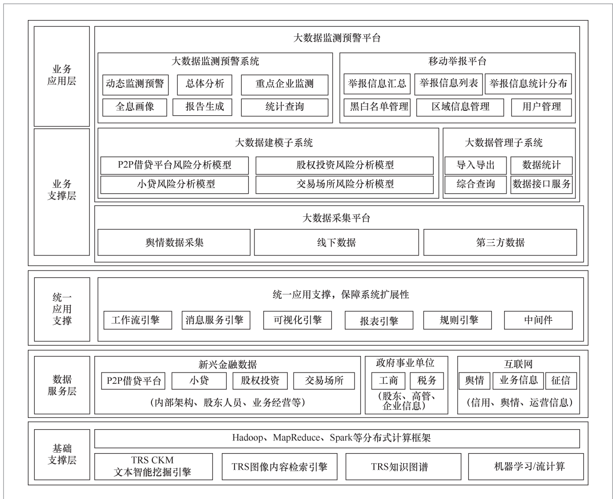
图2 以冒烟指数为核心技术的大数据预警系统构架
