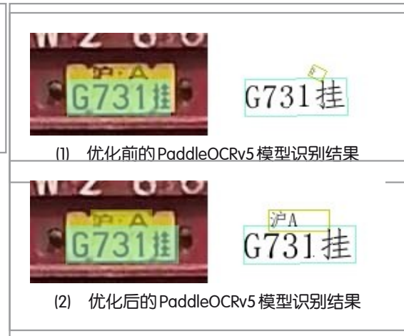
图3 较清晰货车车牌识别结果
