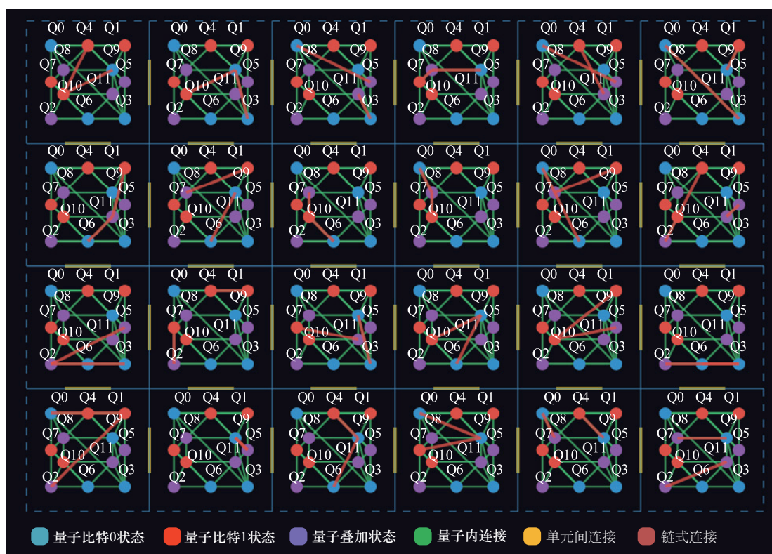
图4 D-Wave Advantage系统采用的Pegasus P16拓扑结构示意图
