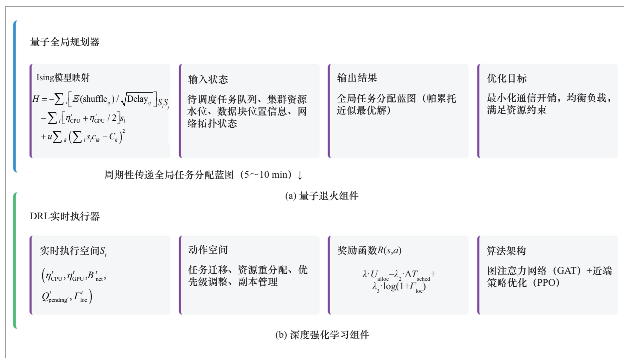
图3 量子-经典分层时序耦合架构
